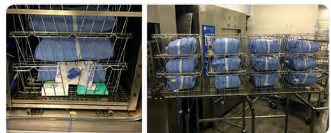
**Figura 1.** Autoclave com a carga de pacotes cirúrgicos de tecido.
