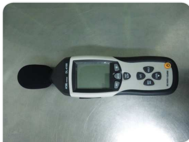
Figura 3. Decibelímetro Icel Manaus DL-4100 ® , aparelho que foi utilizado nas medições. Acervo Pessoal. São José dos Campos (SP), Brasil, 2014.
