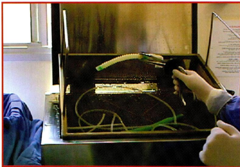
por 60 cm de largura e 40 cm de altura, que contém em seu interior uma resistência para o aquecimento da água, acoplada a um termostato, o qual controla a temperatura programada, com variação de 5°C para cima.
