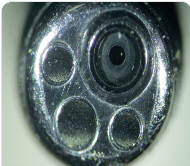
Figura 3. Visualização da mesma fibra, após 18 meses de uso, sem excedente de material adesivo se desprendendo. Data: janeiro de 2015.
