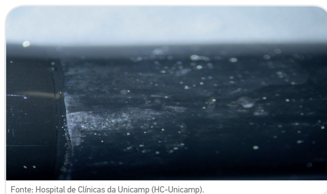
Figura 1. Manchas no corpo do nasofibrocópio visualizadas antes do primeiro uso. Data: setembro de 2013.
