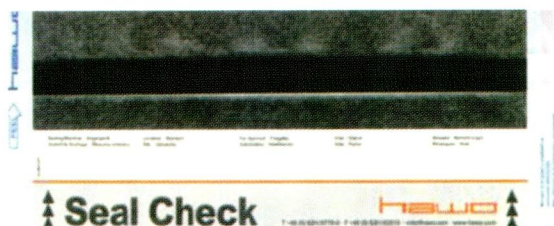
Figura 1 - Indicador de selagem mostrando correta faixa de selagem sem vincos, bolhas ou falhas.
